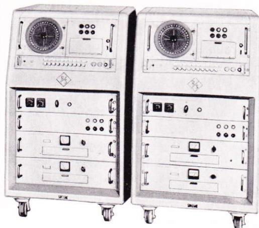
Bei den mobilen Anlagen ist das Peilantennensystem leicht zerlegbar ausgebildet, desgleichen sind die Gestelle mit Schwingrahmen versehen.
