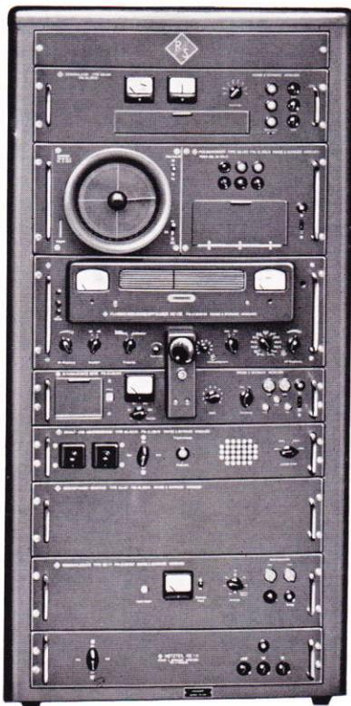
Abb. 4 Peileinrichtung der stationären Einkanalanlage NP 4/F 10/1 mit 10 Peilfrequenzkanälen und Frequenzfernwahl. Für mobile Verwendung kann diese Anlage mit Schwingrahmen ausgerüstet werden (Bezeichnung dann NP 4/MT/F 10/1).
